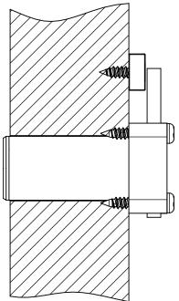
**LOCK IS SHOWN IN LOCKED POSITION FOR** STANDARD DRAWER APPLICATIONS.
